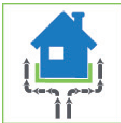
Prinsippskisse for plassering av Protan RadonSafe i bruksklasse B og C.
